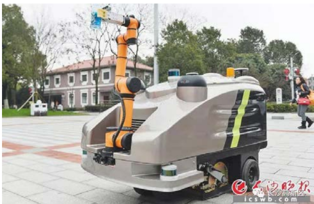
橘子洲景区地铁2号线1号出口广场，一台智慧清捡保洁机器人正在演示自动抓取垃圾。
